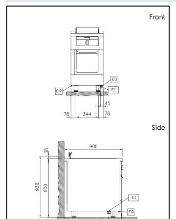
Electrical inlet (power) EQ **Equipotential screw**
